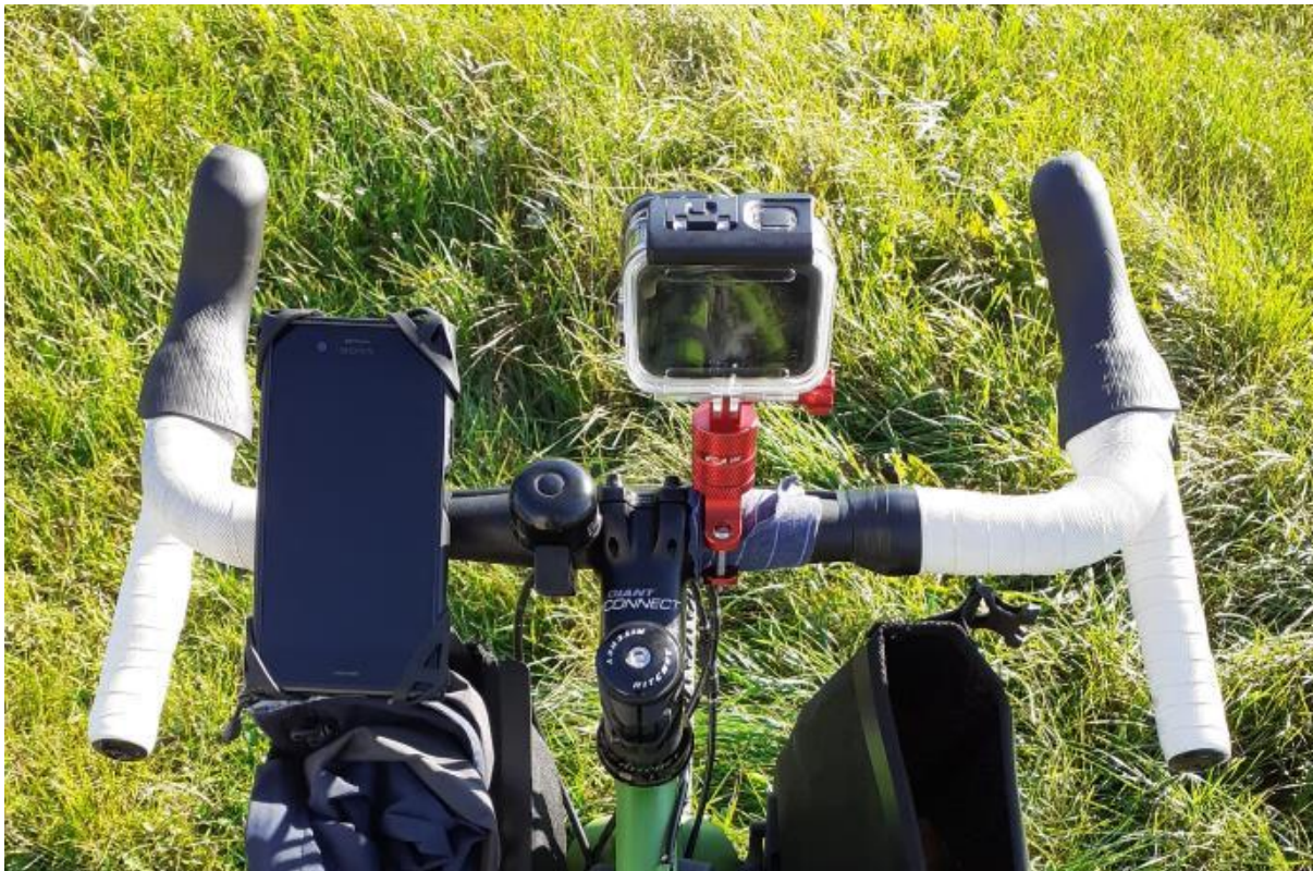
Abbildung 13: Am Fahrrad montierte Action Kamera und Smartphone zur Unterstützung der Kartierung. Eigene Aufnahme.
