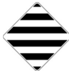
Abb. 54. Binnenschifffahrtszeichen zur Kennzeichnung von Einfahrten
